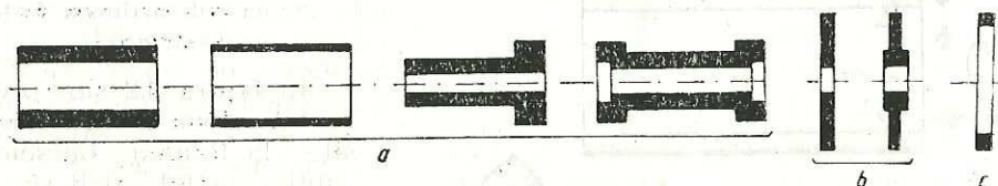
Fig. 3.1. Piese cu suprafețe coaxiale: a — bușe; b — discuri; c — inel.
