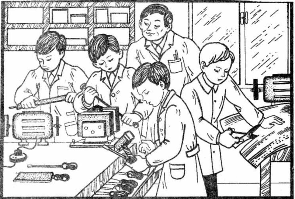
Pierre lime une pièce en métal fixée dans un étau. Victor façonne une pièce pour un moteur électrique. Ils sont dans l'atelier de serrurerie de l'école.
