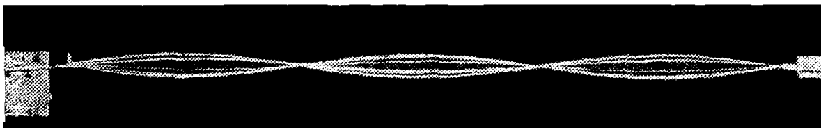
Fig. 3.34. Aspectul firului din figura 3.32 pentru prima, a doua și a treia armonică (a,b,c) și fotografiile stroboscopice ale corzii corespunzătoare.
