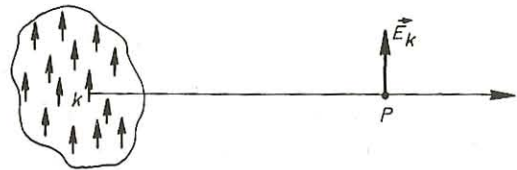
Fig. 7.10. Sursă de lumină formată din N dipoli emițători orientați după o singură direcție.
