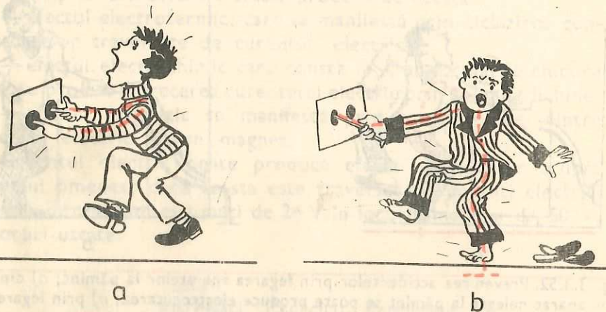
Fig. 3.3.50. Electrocutări prin imprudență; a) scurtcircuitarea prizei cu degetele; b) atingerea unui conductor al prizei cu un cui metalic.
