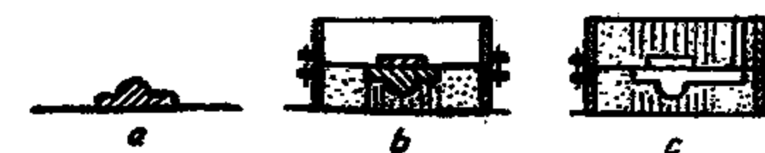
Fig. 76. Executarea formei de turnare.
